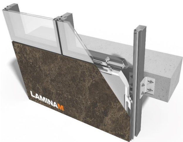
Система сплошного фасада с использованием структурного клея
